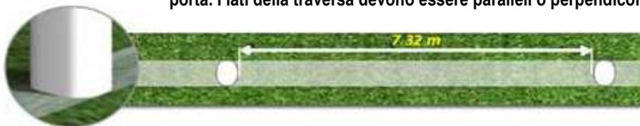
Se la forma dei pali è ellittica (vista dall'alto), l'asse più lungo deve essere perpendicolare alla linea di porta. L'asse più lungo della traversa deve essere parallelo al piano del terreno di gioco.
